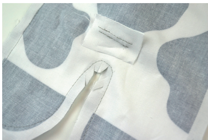
22/ Vystříhneme přebytečný materiál v mezinoží, nastříhneme vnitřní oblinu.
